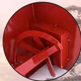
Rotation hydraulique avec moteur ainsi que rotation de la chute sur glissière polyéthylène VHMW.
